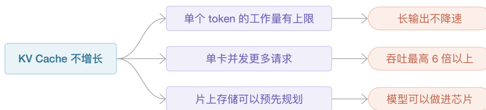
图 4. 存算联动：KV Cache 不增长，同时换来不降速的单请求、更高的吞吐，以及可以做进芯片的模型。
